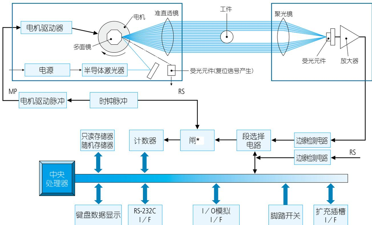
■左图方框图中，从半导体激光器发出的激光束，反射到与时钟脉冲同步高速旋转的多面镜，通过准直透镜改变成为平行光束扫描工件，再通过聚光镜头到达受光元件。
