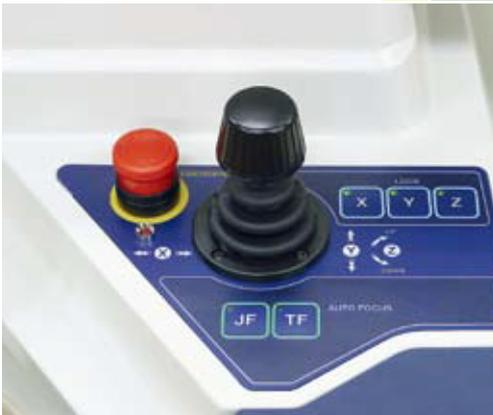
XYZ軸はフロントオペレーションの中枢を担う1本のジョイスティックで駆動操作します。ステージの高速移動から微細な位置決めを行う\* 低速までスピードコントロールが可能です。また、単軸移動の高精度ピッチ測定をサポートするXYZ個別のロック機構を備えています。被検物に集中できることを第一に考えています。
