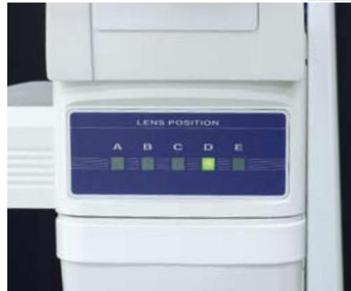
鏡筒に装着した電動レボルバは手元のシートスイッチで操作可能です。レボルバが回転すると鏡筒上部のレンズポジションを表すLEDが点灯しますのでLED表示を見れば現在の倍率を確認することができます。
