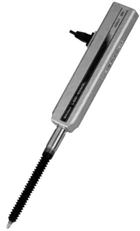
$\varnothing 15\text{mm}$  轴套
