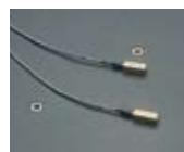
用于测量物的温度传感器
