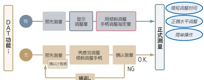
将SJ-410系列安装在简易台架上进行测量时,通过与倾斜载物台\*1、3轴调整工作台\*1、倾斜调整装置\*1等各个选配件的组合,能实现更为简单的水平调整作业。
