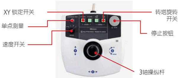
在步进/低/中/高四档下通过操纵杆进行切换工作台的动作速度。
