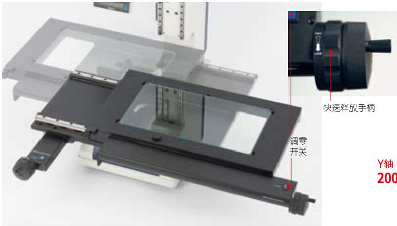
工作台的进给可通过快速释放手柄在粗调和微调之间转换（释放 / 锁紧），这在测量距离较长或迅速返回参考位置时非常有用。由于采用 Twist-roller（扭轮摩擦传动机构）方式，使得进给特别平滑。另外，由于调零开关就在手柄附近，在测量过程中，除了显微镜聚焦外您可以一直抓住手柄\*2。
