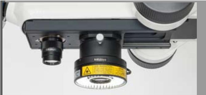
滑动式物镜旋座上安装物镜与环形LED照明的示例
