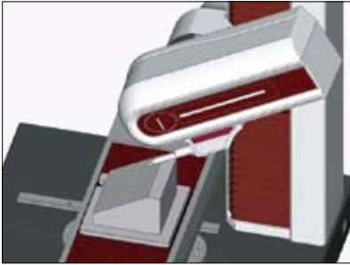
X轴方向的斜面测量
