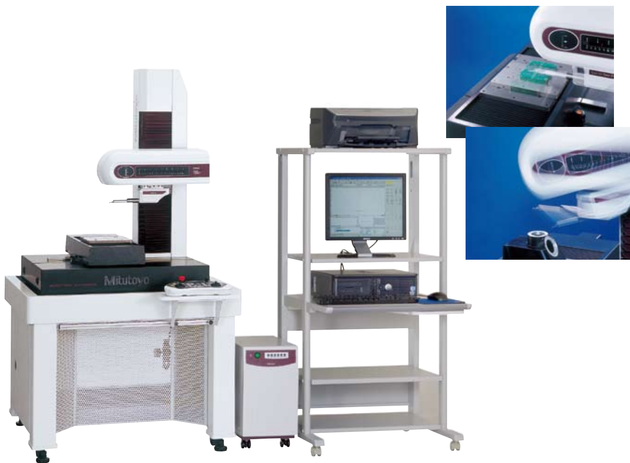
SV-3000CNC (驱动部倾斜结构+附带Y轴工作台)
