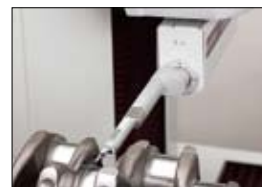
(测量实例)旋转型检出器 (检出器:向后)
