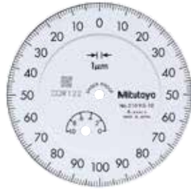
分度值: 0.001mm, 测量范围: 1mm 防震型 宝石轴承型
