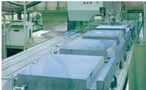
大型研磨机上的三坐标测量机花岗岩研磨工作台
