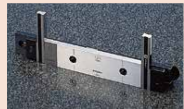
无孔的量规和各种量爪的结合示例
