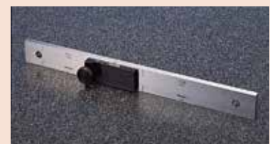
长量块的连接孔
