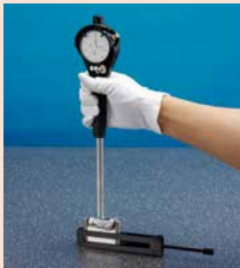
使用支架，一对 I 型的半圆量爪作为平台来校准孔径表。
