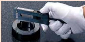
使用一对半圆量爪和一个支架对小孔进行测量
