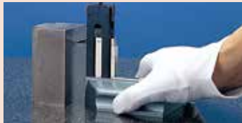
使用基座，一个支架和划线器量爪给工件划线
