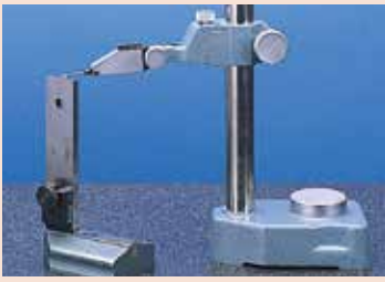
通过使用 D 型支架，将一个长量块连接到基座上
