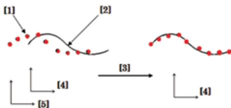
[1] 测量点 [2] 拟合数据参照文件 [3]\*\* 拟合 [4] 标准坐标系 [5] 测量坐标系
