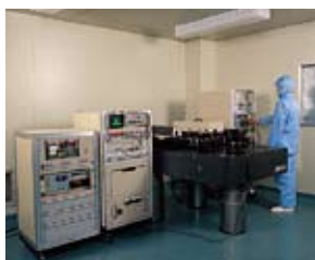
长度基准用 633nm 碘分子吸收线 波长稳定的 He-Ne 激光装置
