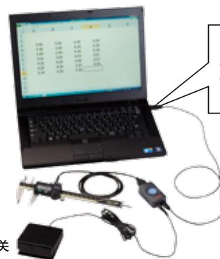
当连接到USB端口时, HID\* 键盘装置(标准Windows驱动软件)可自动被识别。
