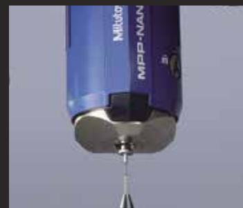
使用MPP-NANO测针进行测量
