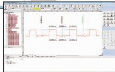
通过HQVWL测量印刷电路板的线宽、线距及导体厚度的示例
