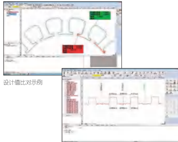
通过HQWLI测量印刷电路板的线宽、线距及导体厚度的示例
