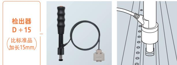
适用于空隙、槽、表面段差部位的硬度试验
